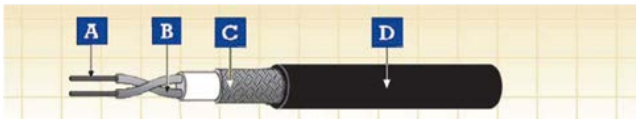
A. 导体 B. 绝缘 C. 屏蔽 D. 护套
