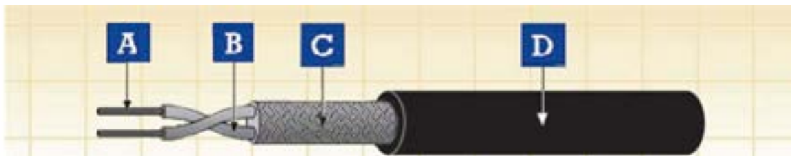
A. 导体 B. 绝缘 C. 屏蔽 D. 护套
